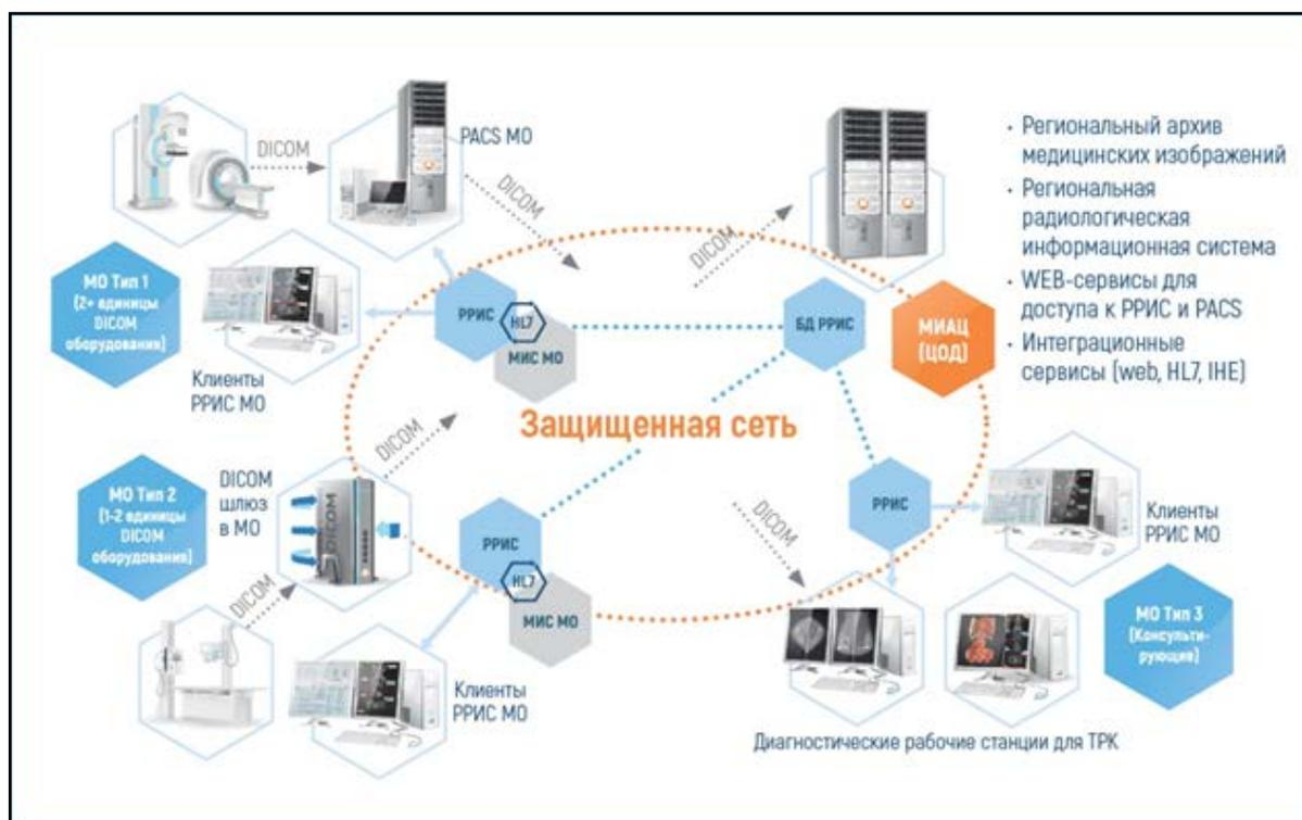
Рисунок 4 – Общая схема РРИС
